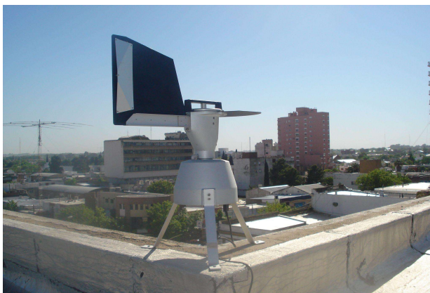
Figura 1. Muestreador volumétrico Lanzoni VPPS 2000, instalado desde el año 2007 en el centro urbano de Santa Rosa, La Pampa, Argentina.
